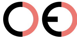
Falsche CE-Kennzeichnung (zu großer Zwischenraum)
