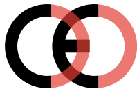
Falsche CE-Kennzeichnung (zu dicht)
